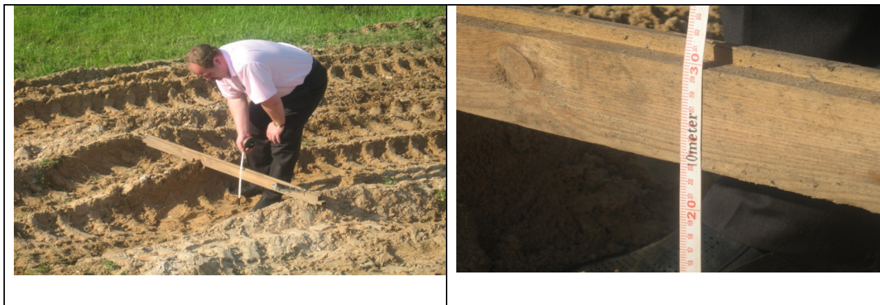
Образованная колея на слабом грунте без применения геоболочки
