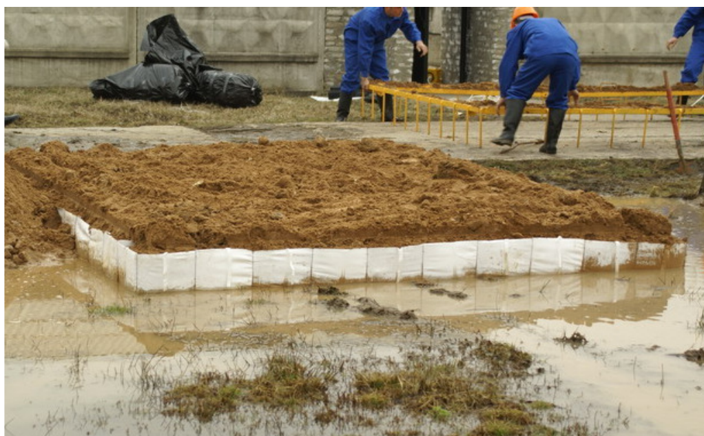
Рис. 1 Общий вид исследуемой конструкции геоболочки
