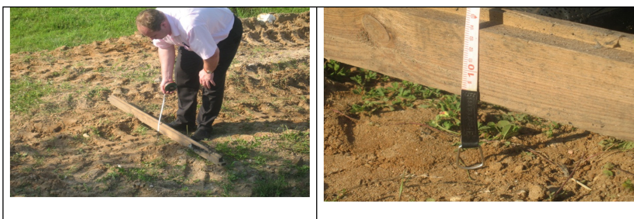
Образованная колея на слабом грунте с применения геоболочки
